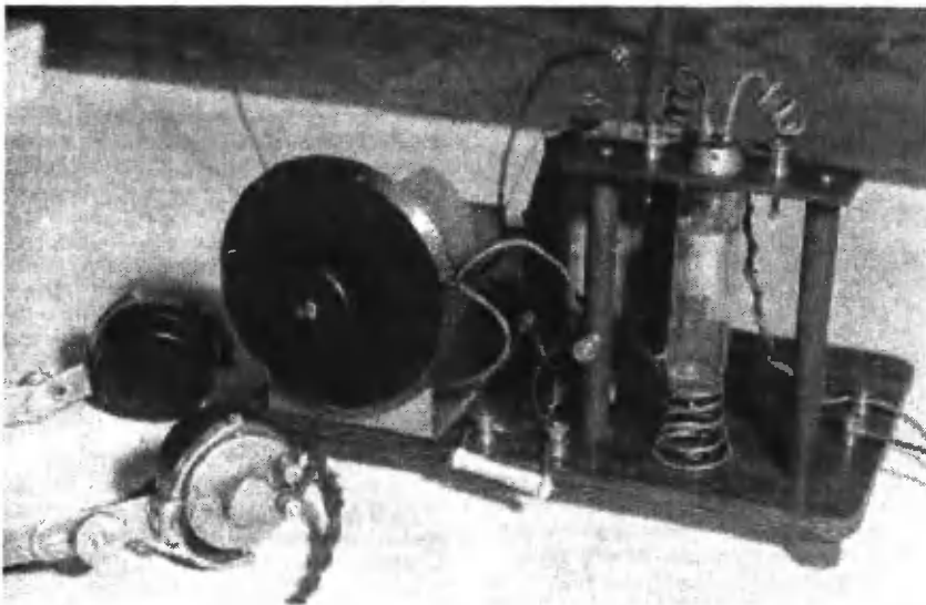
Рис.10. Общий вид радиоприемника на двухэлектродной лампе конструкции А.Флеминга. 1905 г.
